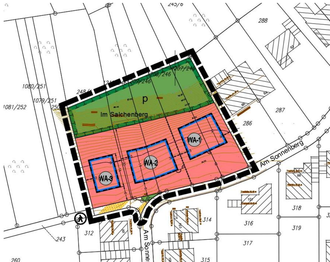
Abb. 8: Anschluss an die vorhandene Bebauung und den bestehenden Bebauungsplan
